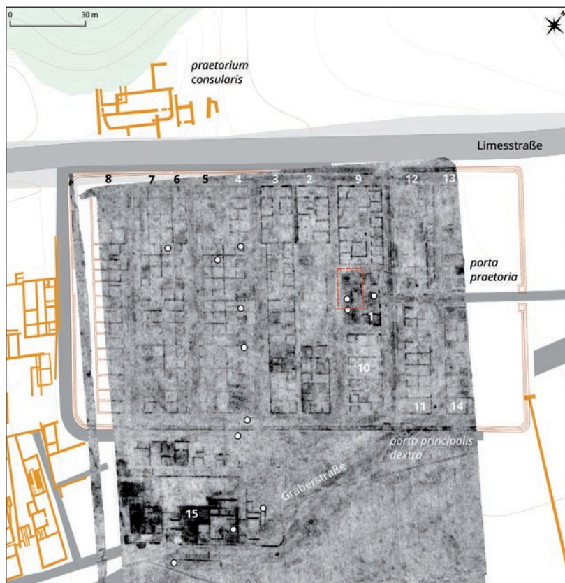
1 Carnuntum. Bodenradarmessungen im Bereich des Statthaltersitzes. Die Lage der Rammkernbohrungen (Kreise) und der Grabungsfläche (rot strichliert) sind markiert | Carnuntum. Ground penetrating radar measurements in the area of the governor's seat. The location of the ram core drillings (circles) and the excavation area (dashed red) are marked (© LBI ArchPro/GeoSphere Austria, M. Wallner; ÖAW-ÖAI, C. Gugl)
