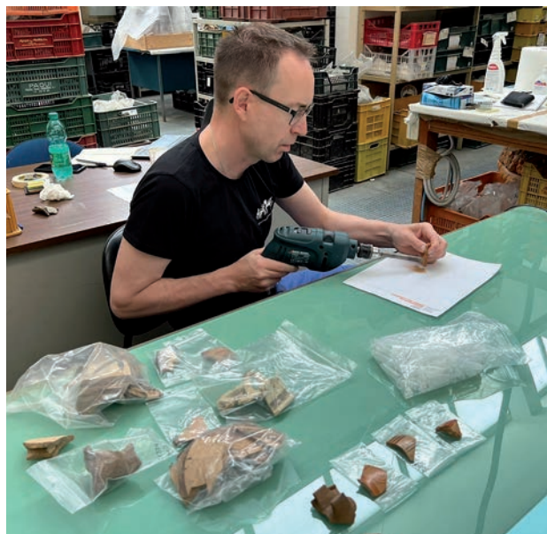
7 Beprobung einer mykenischen Scherbe aus Roca Vecchia mittels eines Korundbohrers für die Neutronenaktivierungsanalyse | Sampling of a Mycenaean sherd from Roca Vecchia for neutron activation analysis by using a corundum drill (Foto: T. Scarano)
